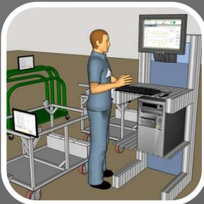
Attraverso una web application l'operatore invia i dati da visualizzare a un determinato carrello
